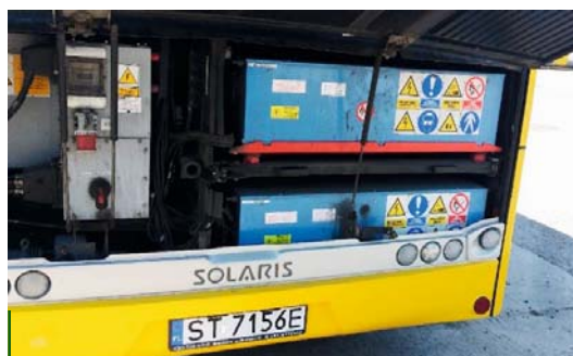
Trolejbus z zabudowanymi bateriami trakcyjnymi typu STH600 x84
