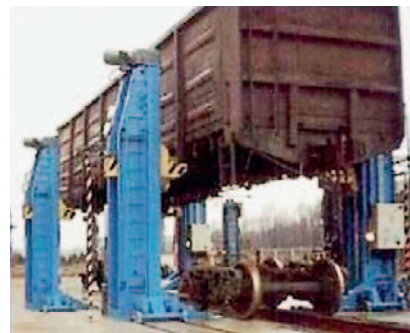
Rys. 1. Podnośniki typu Kutruffa. Źródło: Katalog urządzeń i przyrządów pomiarowych. MTL ASCO RAIL Sp. z o.o. ( www.ascorail.eu )
